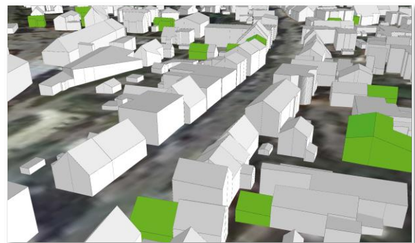
Beispiele von Aufstockungspotenzialen Typ C Ergebnisse der automatisierten Ermittlung basierend auf dem 3D-Gebäudemodell & ALKIS-Daten
